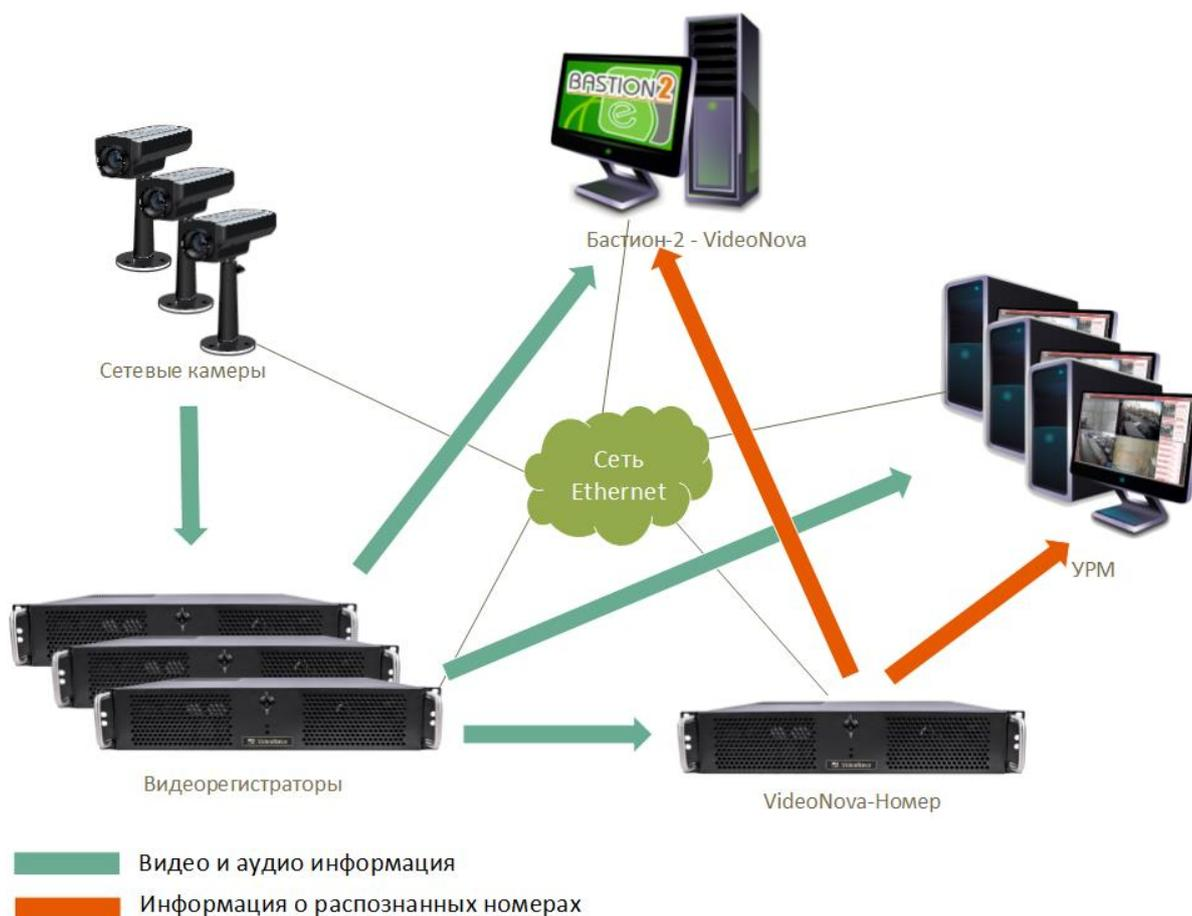
**Рис.1. Структурная схема ЦСВ VideoNova**
